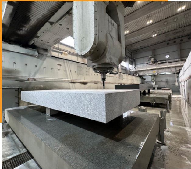
Nach Sichtung eines Blockes durch einen Bearbeiter wird anhand von Tastzyklen die Lage des Granitblockes auf der Maschine ermittelt und die Oberflächen für die weitere Bearbeitung kartographiert.
