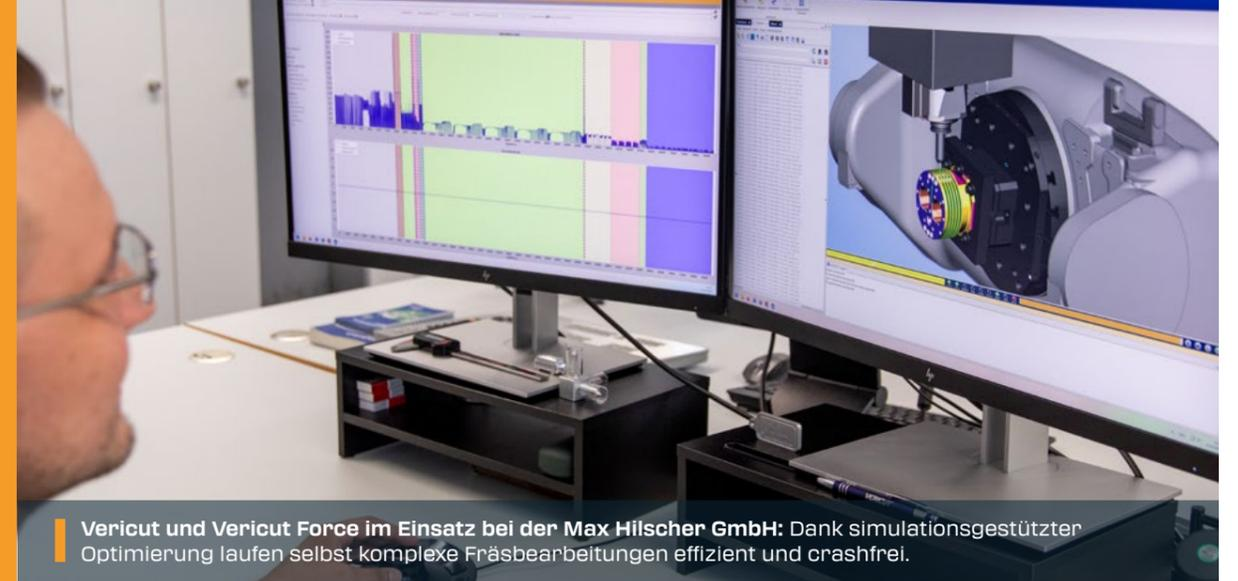
Vericut und Vericut Force im Einsatz bei der Max Hilscher GmbH: Dank simulationsgestützter Optimierung laufen selbst komplexe Fräsbearbeitungen effizient und crashfrei.
