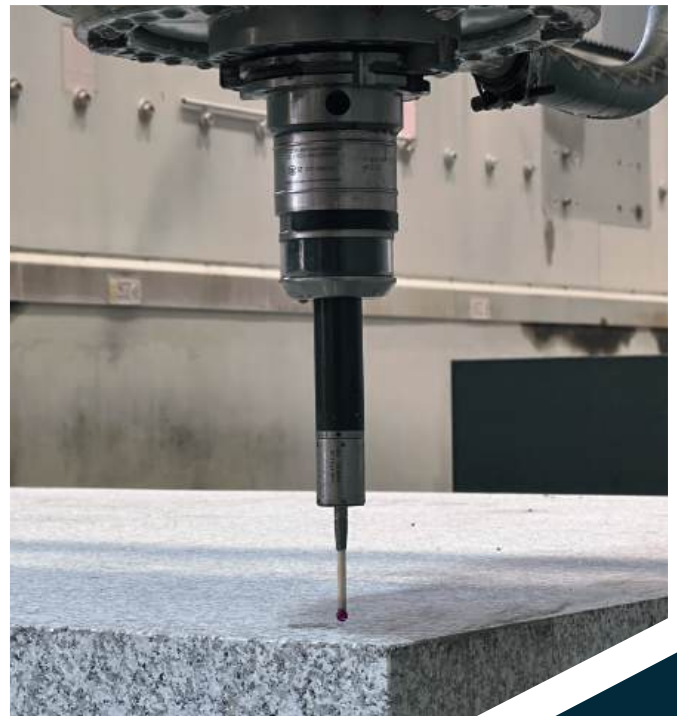
Nach Sichtung eines Blockes durch einen Bearbeiter wird anhand von Tastzyklen die Lage des Granitblockes auf der Maschine ermittelt und die Oberflächen für die weitere Bearbeitung kartographiert.
