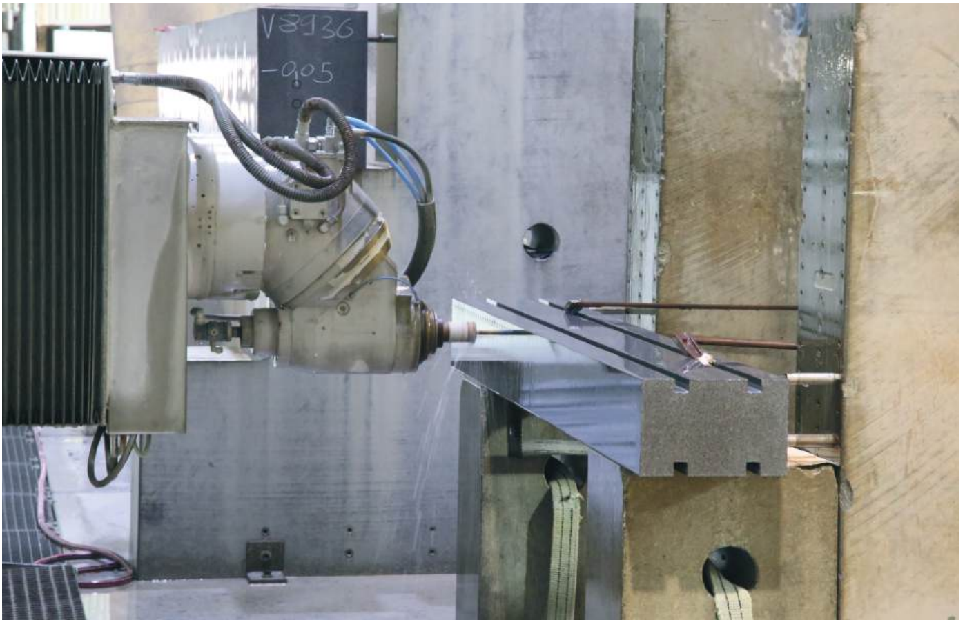
Auf der Fahrständerbohrwerke werden die Bohrungen für die Gewindeinsätze zur Montage von Linear-Führungsschienen, Antrieben, Messsystemen und Anbauteilen gemacht.
