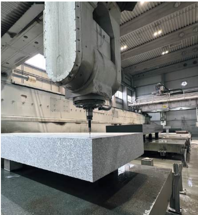
Nach Sichtung eines Blockes durch einen Bearbeiter wird anhand von Tastzyklen die Lage des Granitblockes auf der Maschine ermittelt und die Oberflächen für die weitere Bearbeitung kartographiert.
