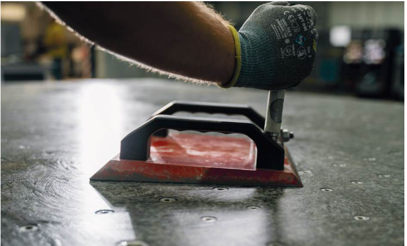
Die Endbearbeitung durch Feinläppen in vollklimatisierten Feinmessräumen bei 20 (\pm 0,2)^\circ\text{C} ermöglicht eine reproduzierbare Ebenheitstoleranz von 1\mu\text{m} .
