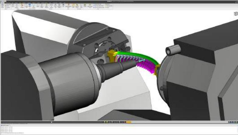
Werkzeugmaschinen-Käufer wollen natürlich gern vor dem Kauf wissen, was die Maschine im konkreten Anwendungsfall zu leisten im Stande ist. Also schlägt Starrag wie bereits skizziert mittels NC-Simulation eine Brücke in die Zukunft: Das echte NC-Programm des Kunden wird auf der virtuellen Maschine in Vericut auf Kollisionen etc. geprüft. Der reale Prozess wird auf Basis des
