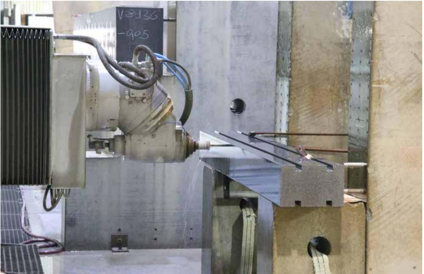
선형 가이드 레일, 구동 장치, 스피들, 측정 시스템 및 부속품을 마운트하기 위한 홀 가공에는 칼럼 이동형 장비(boring machine)로 가공합니다.
