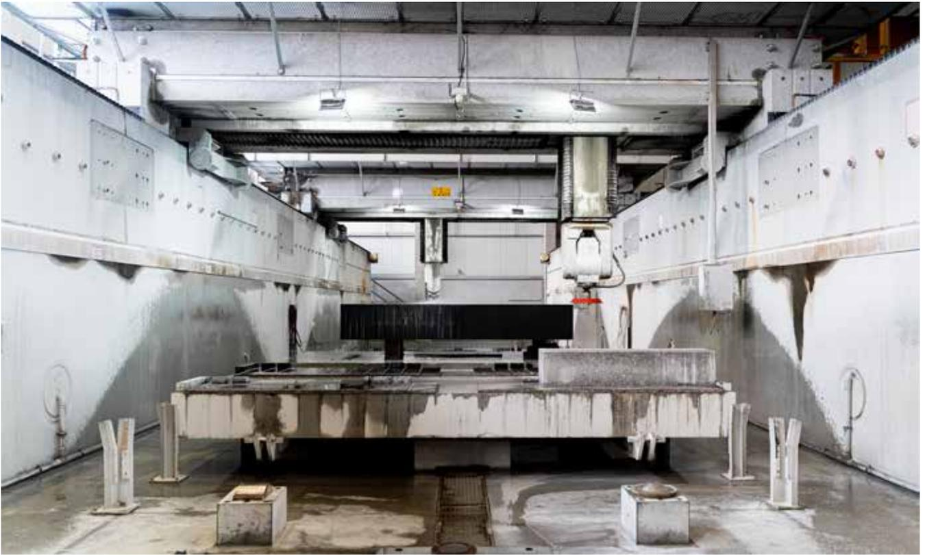
고정밀 장비 부품, 측정 테이블 및 플레이트 생산에 필요한 화강암 원석 블록이 몇 밀리미터의 가공 여유를 두고 크기에 맞게 절단됩니다.
