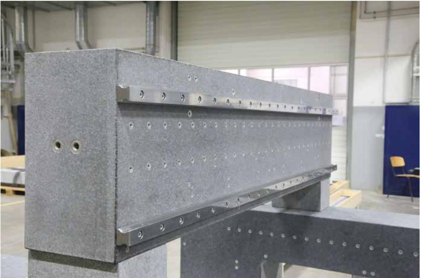
할로우 드릴 코어 가공 후 스테인리스 나사를 접착제로 고정합니다. 위치 정확도는  $< \pm 0.1\text{mm}$ 입니다.
