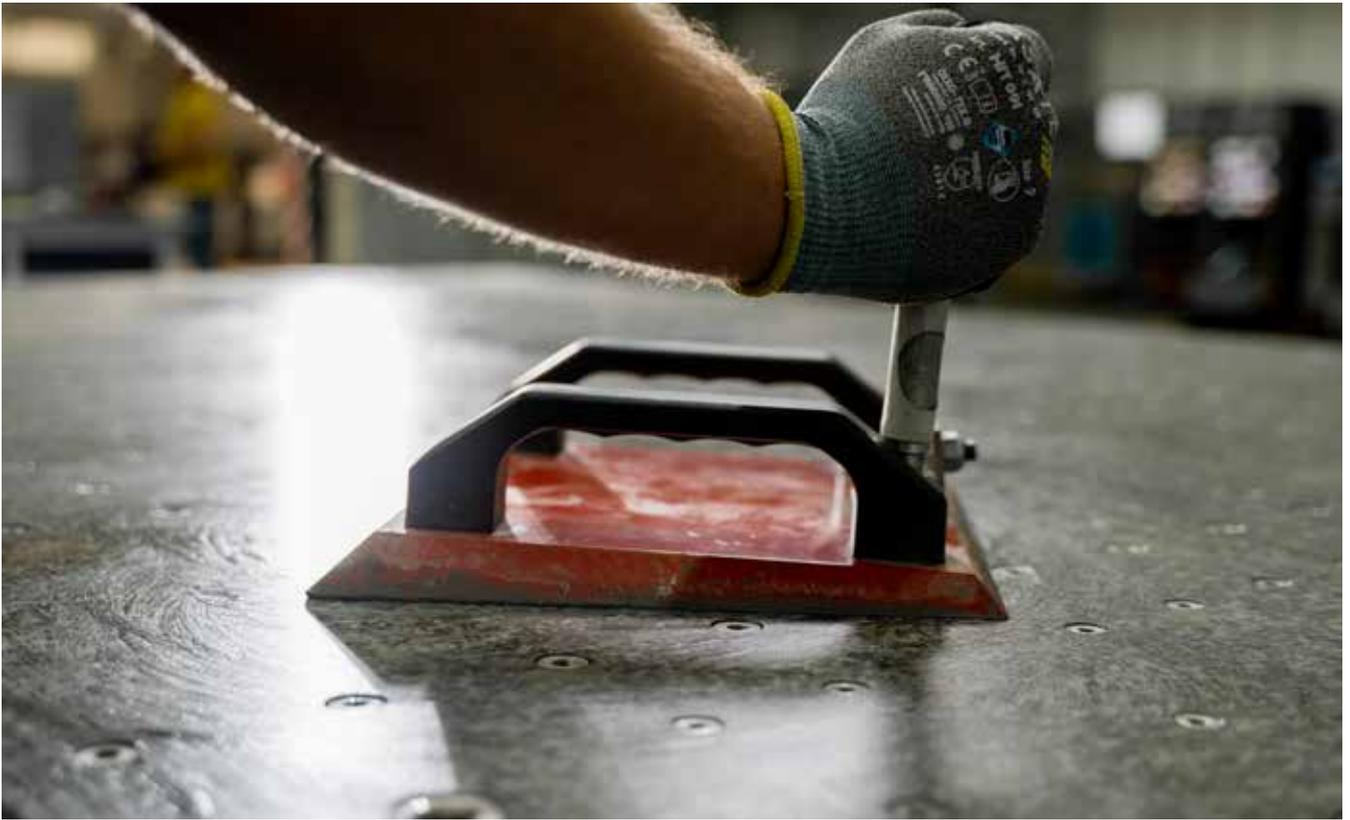
완벽하게 에어컨 시설이 된 정밀 측정실에서 표면 공차  $1\mu\text{m}$  이내로 미세 래핑(fine lapping) 가공을 진행합니다.
