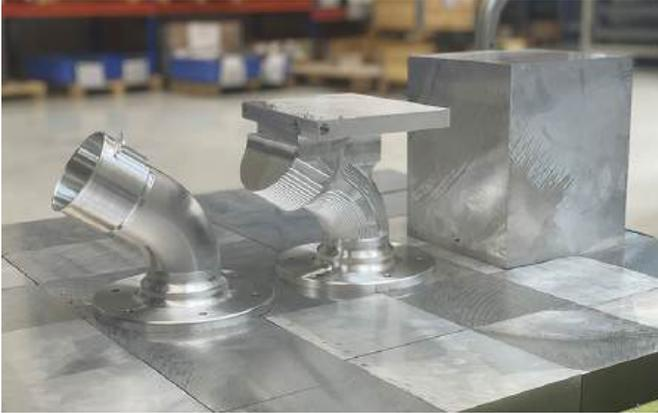
Bei Bauteilen wie diesen liegt der der Zerspanungsanteil bei rund 95 Prozent. Durch die Optimierung des NC-Programmbetriebs mit Vericut Force konnte RO-RA die Bearbeitungszeiten deutlich reduzieren.
