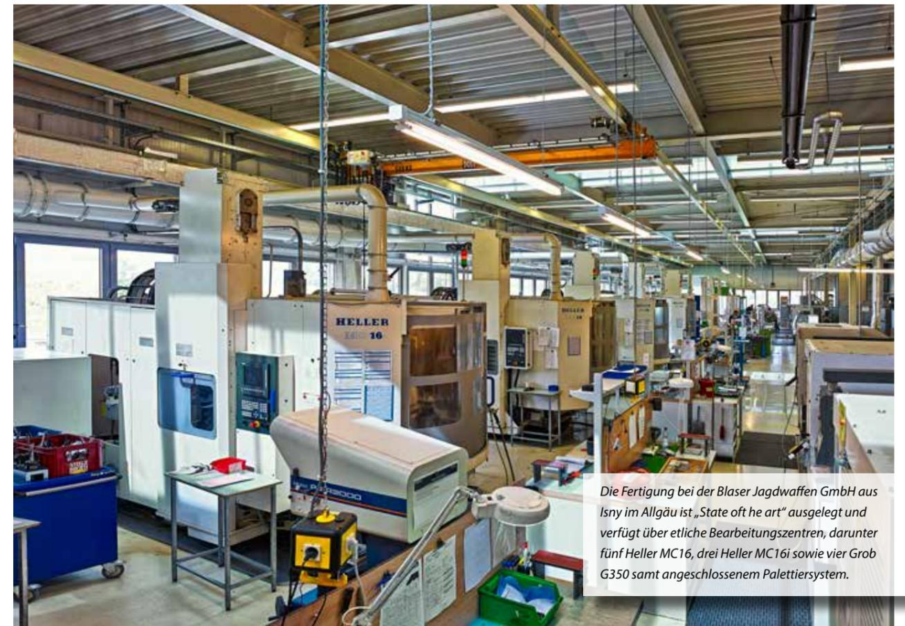
Die Fertigung bei der Blaser Jagdwaren GmbH aus Isny im Allgäu ist „State of the art“ ausgelegt und verfügt über etliche Bearbeitungszentren, darunter fünf Heller MC16, drei Heller MC16i sowie vier Grob G350 samt angeschlossenen Palettiersystem.
