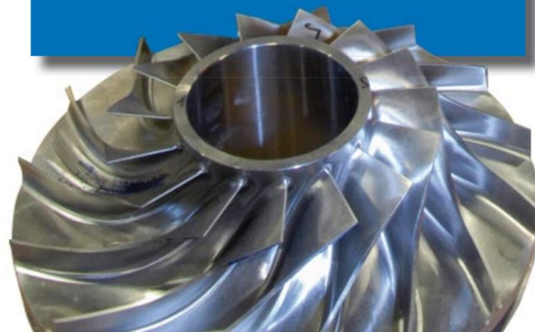
Allein im Jahr 2010 verzeichnete Elliott 27 Ausschuss-Teile durch Programmierfehler. Die meisten Fehler gingen auf Verletzungen der Kontur, oder auf Kollisionen mit den Werkzeughaltern zurück. In anderen Fällen wurde das Werkzeug im Eilgang über das Werkstück verfahren.
