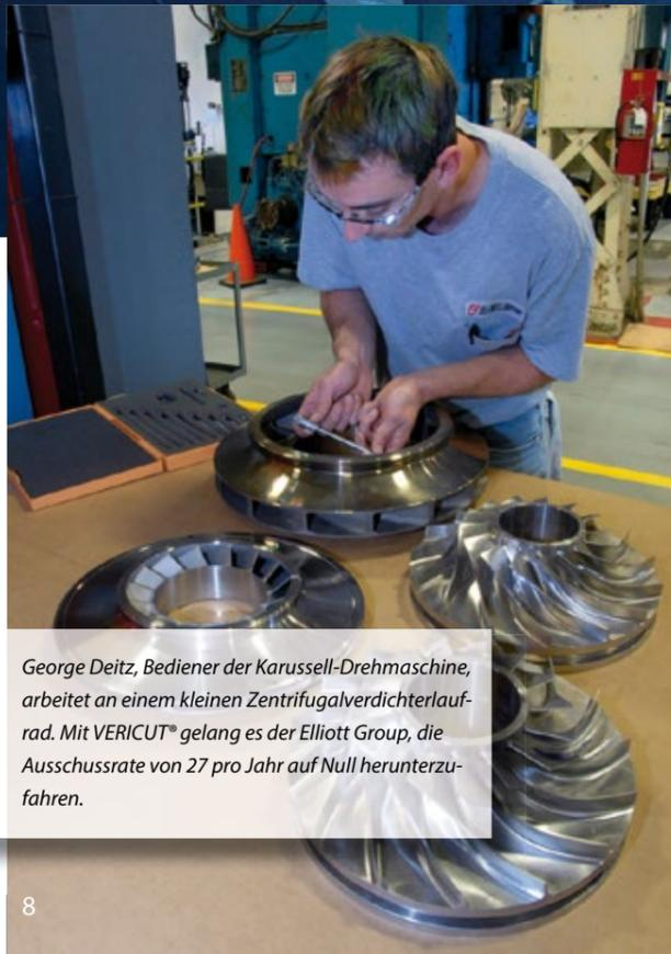
George Deitz, Bediener der Karussell-Drehmaschine, arbeitet an einem kleinen Zentrifugalverdichterlauf-rad. Mit VERICUT® gelang es der Elliott Group, die Ausschussrate von 27 pro Jahr auf Null herunterzufahren.
