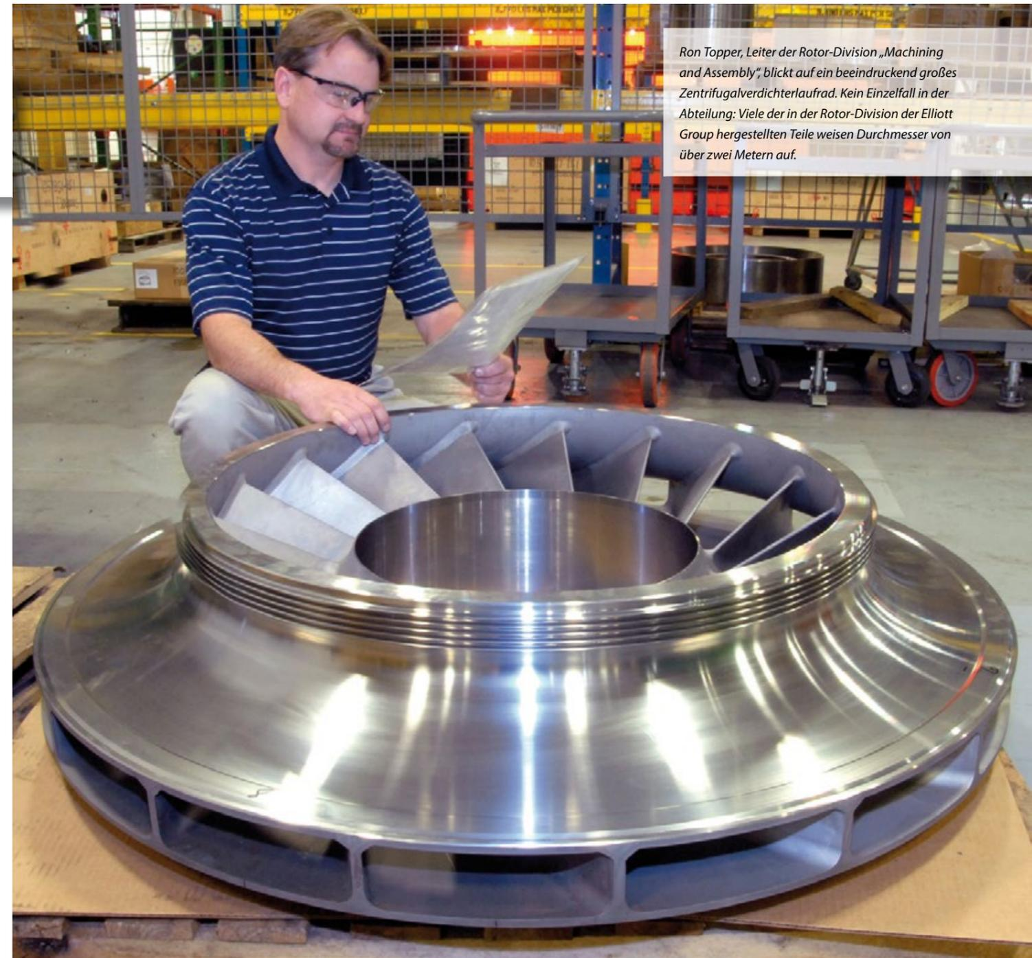
Ron Topper, Leiter der Rotor-Division „Machining and Assembly“, blickt auf ein beeindruckend großes Zentrifugalverdichterlaufrad. Kein Einzelfall in der Abteilung: Viele der in der Rotor-Division der Elliott Group hergestellten Teile weisen Durchmesser von über zwei Metern auf.
