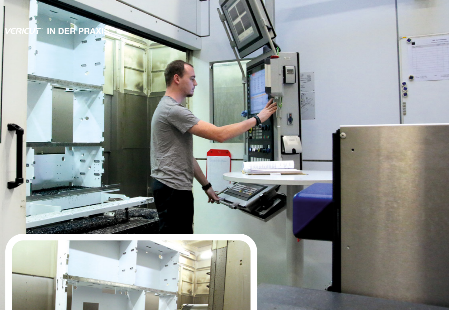
Bei Trumpf Maschinen Austria werden Rahmen und Druckbalken für die in Pasching produzierten Biegemaschinen unter anderem auf einer ELHA SMX 5239 gefertigt (Anm.: Im Bild ein Grundrahmen für den ToolMaster).
