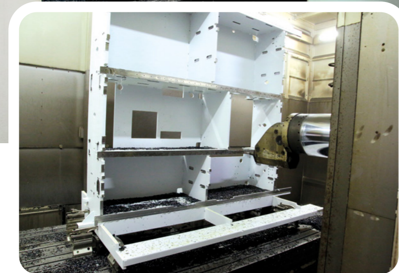
Bei Trumpf Maschinen Austria werden Rahmen und Druckbalken für die in Pasching produzierten Biegemaschinen unter anderem auf einer ELHA SMX 5239 gefertigt (Anm.: Im Bild ein Grundrahmen für den ToolMaster).
