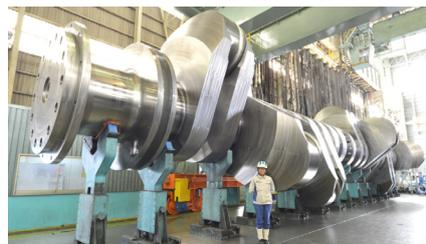
船舶用の超大型「組立型クランク軸」。
