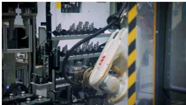
「お客様が注文をすると、それがパラメトリックに基づく自動設計プロセスを開始します。」と、サンドビック・コロマントの生産エンジニア、ビヨルン・リュングレン氏は説明します。「次に、ロボットや測定システム、工作機械用プログラムの自動生成が行われます。機械プログラムの作成には、Vericutを使った詳細な検証とシミュレーションが含まれます。」
