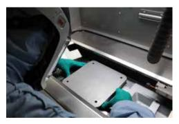
소재를 직접 깎는 전통적 절삭 가공의 경우 첫 가공일지라도 후속 기능의 위치를 작업자가 지정할 수 있습니다. 적층 가공의 경우, 완성된 부품에는 반드시 정렬이 맞아야 하는 부분조차도 사전에 정의된 데이터가 없기 때문에 부품 안의 부품을 찾아야 하는 주조 및 단조 과정과도 비슷하다고 O'Toole는 이야기합니다.
