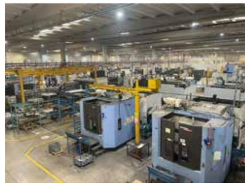
HMS Makina의 신제품 슈퍼바이저인 Onur Benzergil 은 “80대 이상의 최신 CNC 장비를 운용합니다. 알루미늄, 철강 합금, 스테인리스 스틸, 티타늄, 판형 마그네슘/니켈 기반 초합금, 시트, 주물, 단조 등 각종 경금속과 초경합금을 이용하여 정밀하고 복잡한 형상의 부품을 고객의 요구 사항에 맞게 생산합니다.”라고 설명했습니다.
