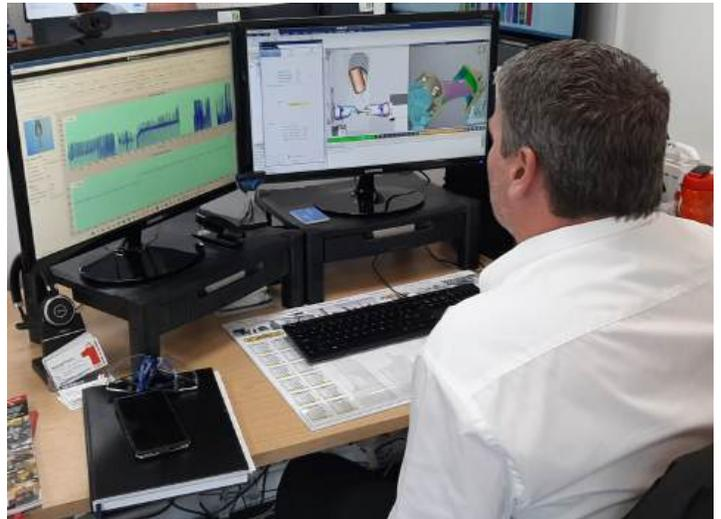
AML dispone di sette postazioni VERICUT, con i moduli base e fondamentali che comprendono Verification (che rileva gli errori di programma e verifica l'accuratezza dei pezzi), CNC Machine Simulation (che rileva le collisioni e i prossimità tra tutti i componenti nella zona di lavorazione) e Multi-Axis (che simula operazioni di fresatura, tornitura e fresatura-tornitura su più assi).
