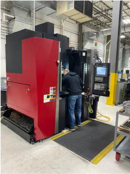
Senkerosionsmaschinen von Makino, die größte davon mit einem Z-Achsen-Verfahrweg von rund 50 Zentimetern. Automatisierte Koordinatenmesstechnik und Bildverarbeitungssysteme von Hexagon und Micro-Vu sind in der Fertigung strategisch positioniert. Alle Maschinen und Anlagen sind in zellenartigen Strukturen für größtmögliche Effizienz angeordnet.
