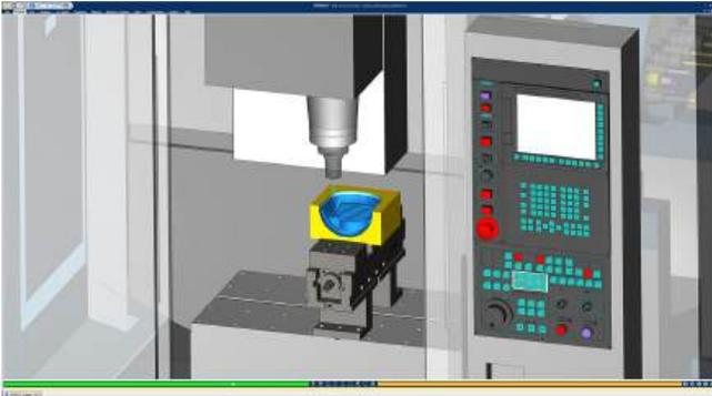
Programm angewendet. Dadurch wurde nicht nur eine sechsstündige Bearbeitungszeit um eine Stunde verkürzt, sondern auch Überlastungen am Werkzeug erfasst und entfernt, die den Fräser mit ziemlicher Sicherheit beschädigt hätte.
