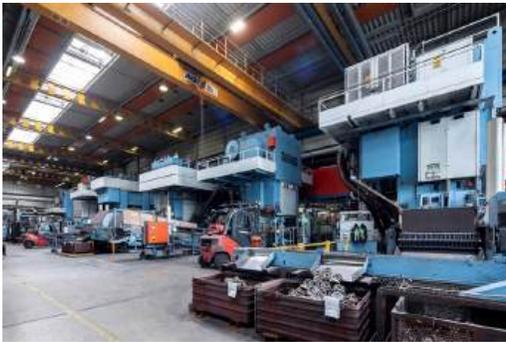
Durch die Kombination der verschiedenen Umformverfahren lassen sich die jeweils spezifischen Technologie-Potenziale nutzen. So kann zur Herstellung eines Bauteils das hohe Umformvermögen der Warmumformung mit der hohen Genauigkeit des Kaltumformens optimal kombiniert werden.
