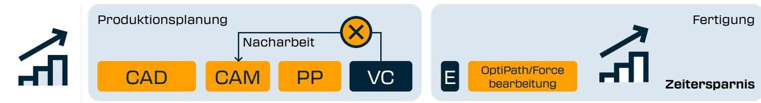
NC-Programme prüfen, ohne kostenintensive Maschinenlaufzeiten an Einfahrteile zu verschwenden. Darum geht's. Vericut simuliert dafür die reale Bearbeitung. Nacharbeiten werden am PC, nicht an
